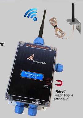
Le TNL120-Tc est une centrale d'acquisition, autonome et étanche, permettant de retransmettre par liaison <mark>radio 3 températures issu de thermocouples, il peut former un réseau maillé de 32 émetteurs.</mark> Les mesures sont mise à disposition par protocole Modbus TCP sur le récepteur SML160Tc
